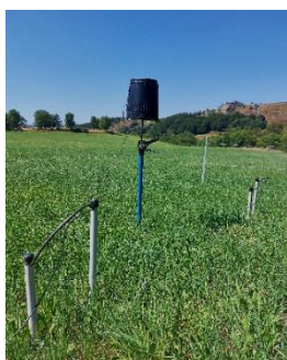
Dispositif de mesures de la tension de l'eau dans le sol (sondes tensiométriques connectées)
