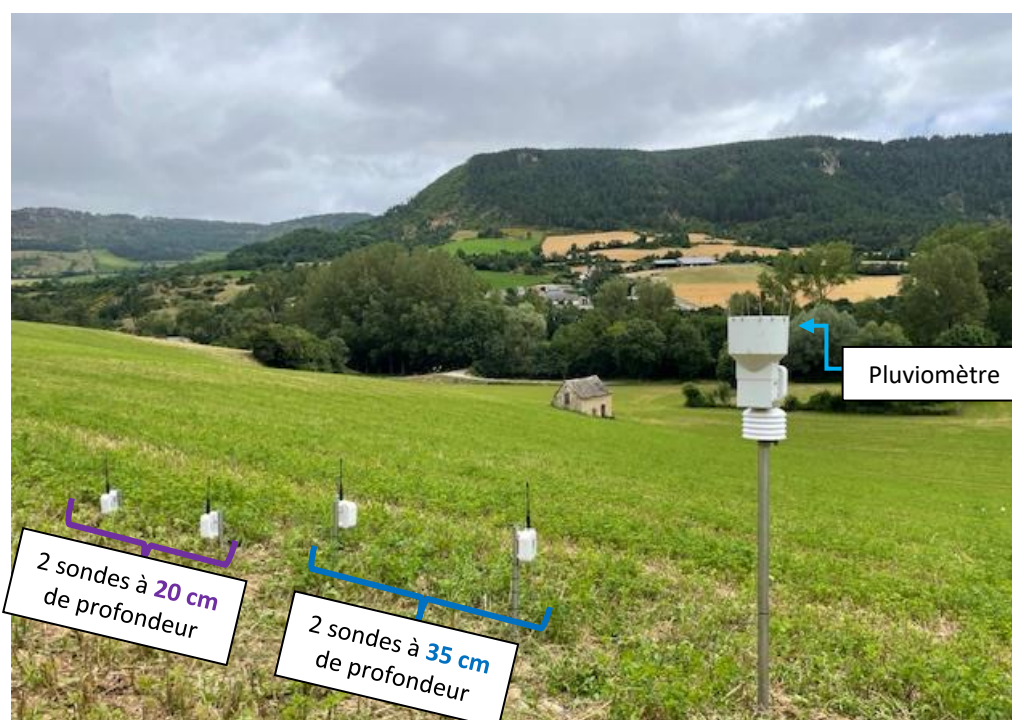
Figure 2 : Photographie du 04/07 des sondes et du pluviomètre de la modalité CA 48
